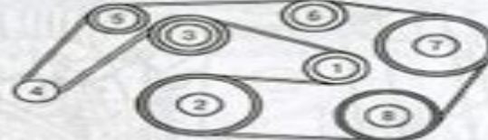
Двигатель OM611: ремень привода вспомогательных механизмов с компрессором кондиционера
