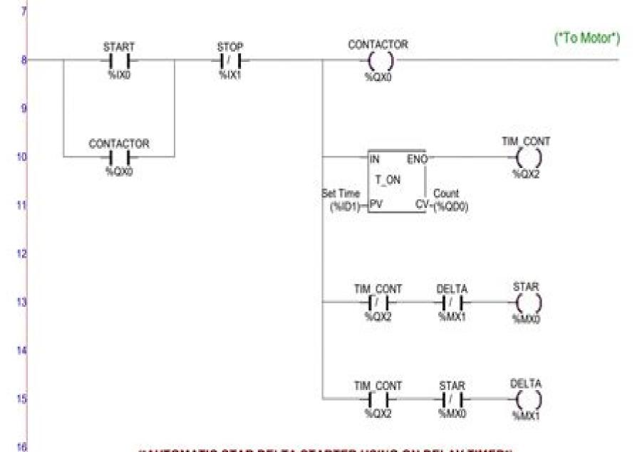
("AUTOMATIC STAR DELTA STARTER USING ON DELAY TIMER")
