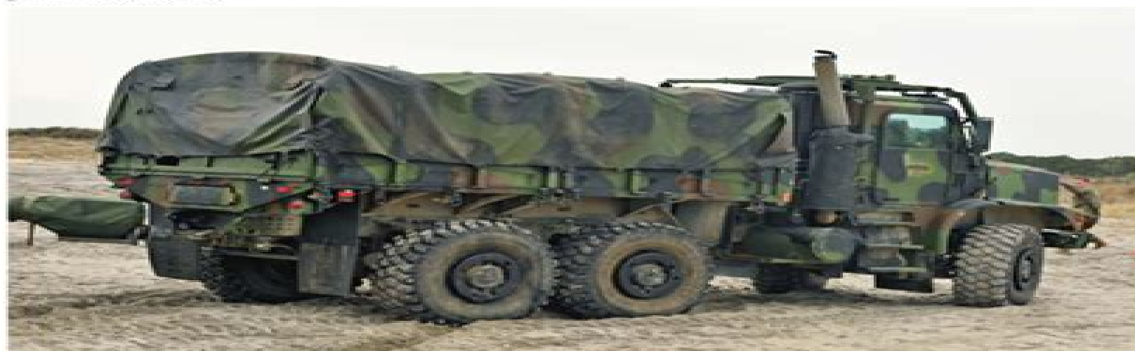
Die drei LKW der Medium Tactical Vehicle Replacement (MTVR) Fahrzeugfamilie wurden für ein Einsatzspektrum von 70% Gelände und 30% Straße konstruiert. Sie können Steigungen von 60% erklimmen, Neigungen von 30% spüren und Gefällewiderstände bis zu einer Tiefe von 1,524 mm ohne vorherige Vorbereitung durchfahren. Ein Reifendrucksystem (CTIS - Central Tire Inflation System) sorgt immer für die richtige Traktion, egal auf welchem Untergrund das Fahren mit Einsatz kommt. The three LKW of the MTVR family were designed for 70% off-road and 30% on-road use. They can negotiate gradients of up to 60% and traverse side slopes angled at up to 30%. They can find water obstacles up to 1,524m deep without preparation. A central tire inflation system (CTIS) ensures perfect traction at all times on whatever surface the vehicles are employed. (Carl Schaefer)
