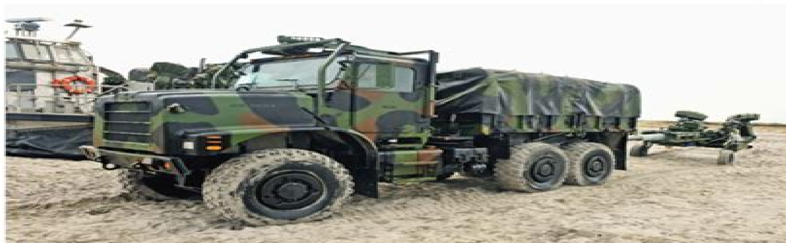
Der MTVR MK23 Cargo Truck wird bei den Artillerieeinheiten des USMC unter anderem als Zugmaschine für die geringste Lightweight 155mm M777A2 Howitzer Feldhaubitze eingesetzt. Dieser MK23 wurde während der Übung Bold Alligator 2012 in Camp Lejeune gesehen. Das Fahrerhaus des Fahrzeuges ist mit dem Weapons Kit ausgestattet, der die Montage von Maschinengewehren oder einem automatischen Granatwerfer erlaubt. While artillery units of the USMC, the MTVR MK23 Cargo Truck is employed as prime mover for the lowest lightweight 155mm M777A2 howitzer. This MK23 was seen at Camp Lejeune during Exercise Bold Alligator 2012. The cab is fitted with the Weapons Kit that allows mounting of different types of machine guns (MG) or an automatic grenade launcher (AGL) (Carl Schaefer)
