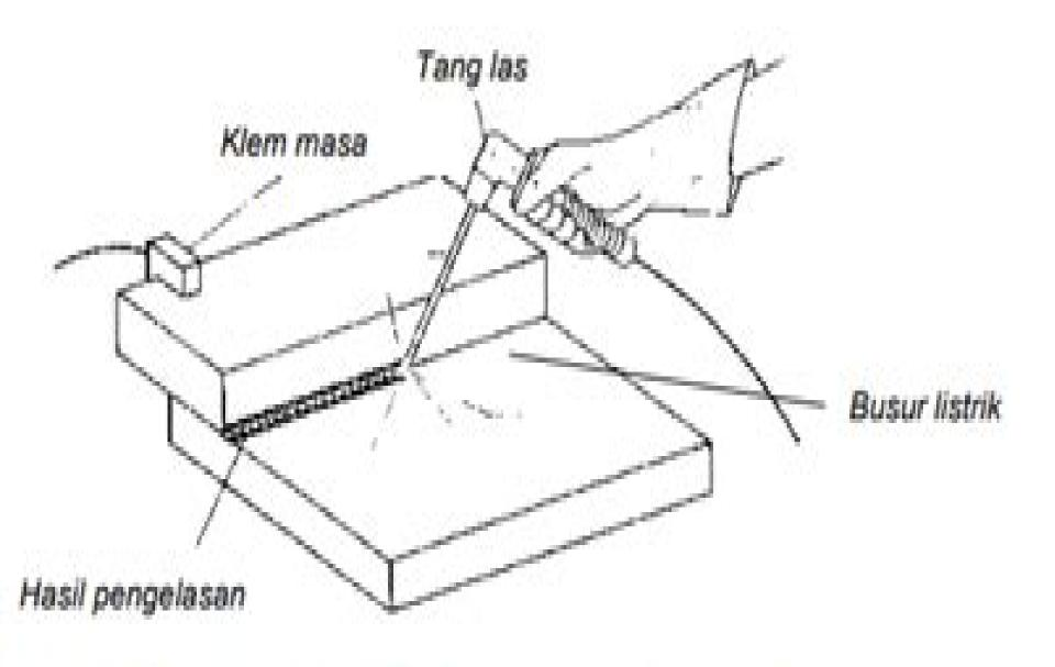
Gambar: Prinsip Kerja Las Busur Manual (LBM)
